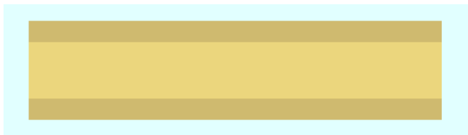
Fig. 6. Una microcinta que consta de dos placas paralelas separadas por un dieléctrico.
